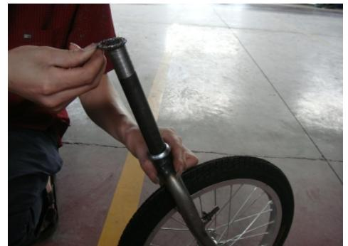
2. nasuňte věneček ložiska na vidlici kuličkami směrem nahoru a vidlici zasuňte do rámu (věneček namažte vazelínou)
