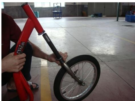
3. nasadte vrchní věneček ložiska na vidlici kuličkami směrem dolů (věneček namažte vazelínou)
